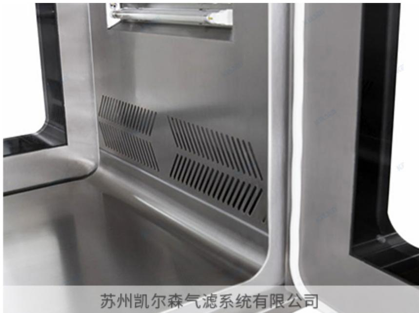
传递窗是洁净室的一种常用辅助净化设备，用于减少洁净室之间的交叉污染和洁净室之前的串流。主要用于洁净区与洁净区、非洁净区与洁净区之间的小件物品的传递，以减少洁净室的开门次数，较大限度的降低洁净区的污染。普通不锈钢传递窗常规的外型尺寸为760\*660\*600mm，内部尺寸为600\*600\*600mm，也可以根据现场情况设计其它尺寸。不锈钢传递窗的常规特点，短距离传递窗工作台面采用不锈钢板，平整光洁耐磨；长距离传递窗工作台面采用无动力滚筒，传递物品轻松方便；两侧门设有机械互锁或电子互锁装置，确保两侧门不能同时处于开启状态。苏州凯尔森可根据客户需要，订制各种非标尺寸的特殊传递窗，也接受定制落地式传递窗。
